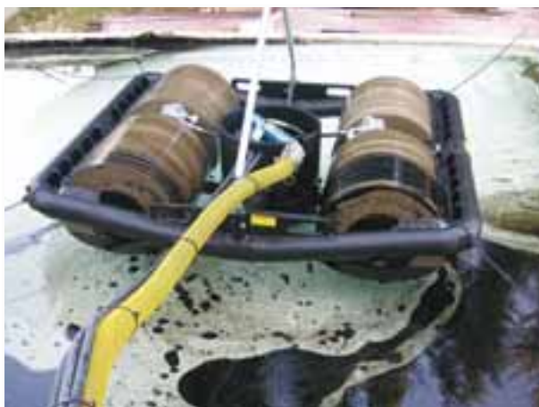
Skimmer disoleatore a rulli mod. SK4-450/2
